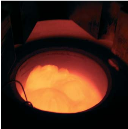
Lit de sable en fluidisation à 900° C à l'intérieur d'un four de chauffe
